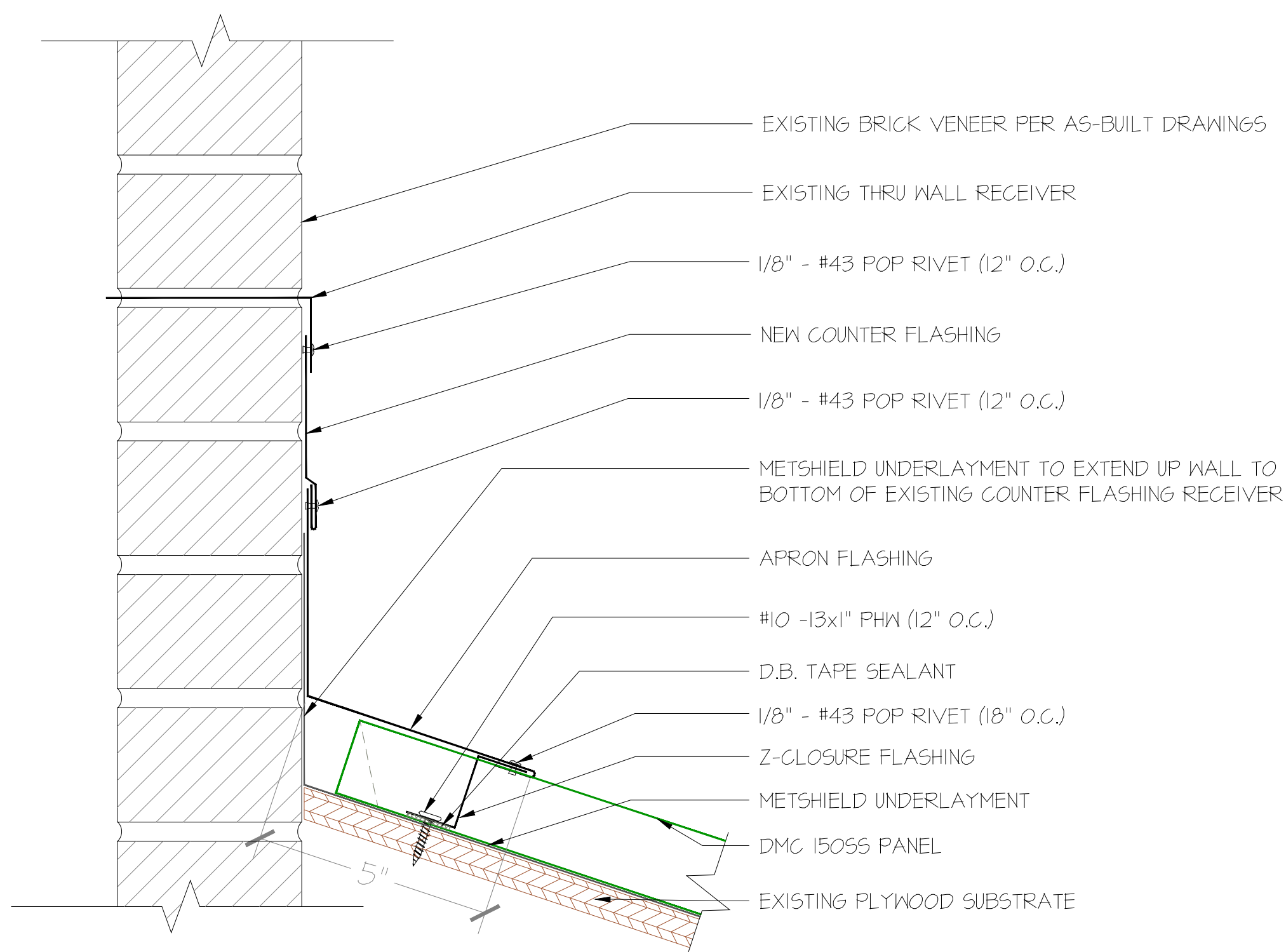
10 APRON FLASHING AT BRICK VENEER RC201 SCALE: N.T.S.
